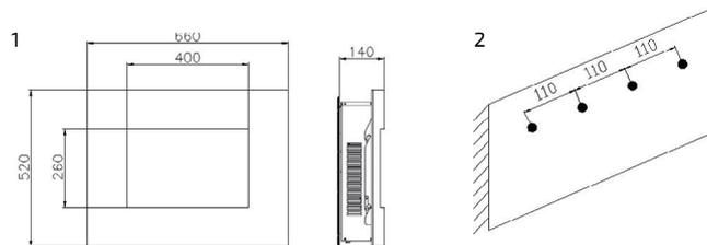
3. Τρυπήστε 4 οπές με πάχος 8 mm και βάθος 26 mm στα 4 σημεία του προηγούμενου σημείου. Τοποθετήστε τις βίδες στις οπές έως ότου είναι στο επίπεδο με τον τοίχο.
