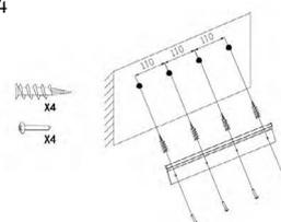
5. Κρεμάστε τη συσκευή στον τοίχο χρησιμοποιώντας τις υποδοχές στο πίσω μέρος της συσκευής. Βεβαιωθείτε ότι η συσκευή είναι εντελώς στερεωμένη στο βραχίονα τοίχου.
